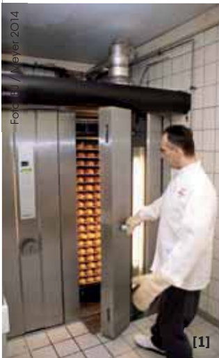
[1] Durch das in der letzten Backphase zugeschaltete BQS-System tritt beim Öffnen der Ofentür nahezu kein Schwaden aus dem Ofen. [2] Neben einer röschen Kruste sorgt das BQS-System für besseres Raumklima. [3] Der Bago-Line-Klimamat ist ein eigenständiges Gerät, untergebracht im pflegeleichten Edelstahlgehäuse. [4] Im Hintergrund ist der neue Fringand-Ringrohretagenofen mit Beschickungshilfe und Elektroetage erkennbar. [5] Bei Miethsam gibt es noch die traditionelle, mit einem Salz-Mehl-Gemisch bestreute Brezel. [6] Neben Berlinern mit dem regional typischen Hefenmark gibt es unter weiteren Sorten neuerdings auch eine trendgerechte „Hugo“-Version.
