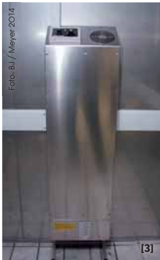
[1] Durch das in der letzten Backphase zugeschaltete BQS-System tritt beim Öffnen der Ofentür nahezu kein Schwaden aus dem Ofen. [2] Neben einer röschen Kruste sorgt das BQS-System für besseres Raumklima. [3] Der Bago-Line-Klimamat ist ein eigenständiges Gerät, untergebracht im pflegeleichten Edelstahlgehäuse. [4] Im Hintergrund ist der neue Fringand-Ringrohretagenofen mit Beschickungshilfe und Elektroetage erkennbar. [5] Bei Miethsam gibt es noch die traditionelle, mit einem Salz-Mehl-Gemisch bestreute Brezel. [6] Neben Berlinern mit dem regional typischen Hefenmark gibt es unter weiteren Sorten neuerdings auch eine trendgerechte „Hugo“-Version.
