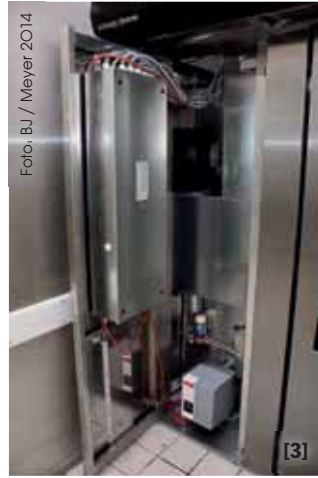
[1] Außenhülle und Backkammer der Futura-Öfen bestehen aus pflegeleichtem Edelstahl. Unter der Bodenplatte befindet sich eine Luftpolster-Unterkonstruktion, die als Isolierung dient. [2] Die Computersteuerung CP-200 ist für 99 Backprogramme ausgelegt und vernetzbar. [3] Wartungsrelevante Teile wie Ölbrenner oder Umwälzventilator sind leicht von vorne erreichbar. Die Steuerung ist wärme geschützt in einem geschlossenen Schrank in der Tür untergebracht. [4] Durch eine auf dem Drehteller angebrachte Galerie können Stikken fast aller Hersteller verwendet werden. [5] Durch diese Öffnung saugt das BQS-System Schwaden gezielt ab.
