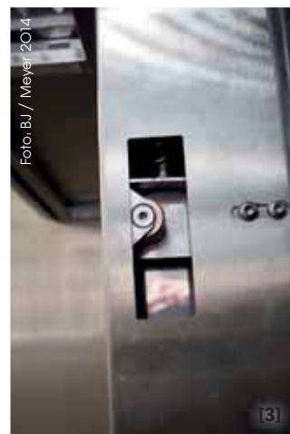
[1] Durch das Lösen zweier Rändelschrauben lässt sich die äußere Türscheibe leicht aufklappen, um die Fenster zu reinigen oder die Leuchtstoffröhre der Backkammerbeleuchtung auszutauschen. [2] Zum sicheren, dampfdichten Schließen der Ofentür befinden sich oben und unten im Türblatt diese schwenkbaren Riegel. [3] Die Messingrollen in der Türsäule mindern den Kraftaufwand beim Schließen und den Verschleiß der Schlossriegel. [4] Zwei Edelstahl-Spezialscharniere heben die Tür beim Öffnen an und schonen so deren Dichtung. [5] Dank dieses simplen Blechwinkels gehören auf dem Boden liegende Ofenhandschuhe endgültig der Vergangenheit an.
