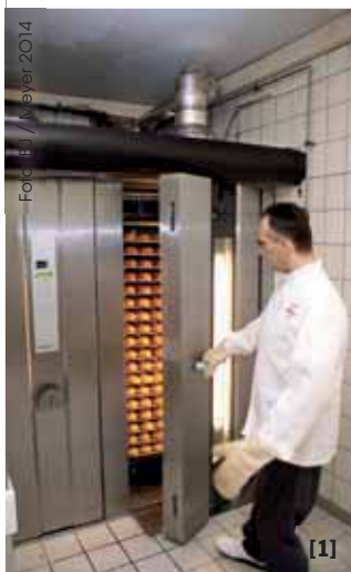
[1] Durch das in der letzten Backphase zugeschaltete BQS-System tritt beim Öffnen der Ofentür nahezu kein Schwaden aus dem Ofen. [2] Neben einer röschen Kruste sorgt das BQS-System für besseres Raumklima. [3] Der Bago-Line-Klimamat ist ein eigenständiges Gerät, untergebracht im pflegeleichten Edelstahlgehäuse. [4] Im Hintergrund ist der neue Fringand-Ringrohretagenofen mit Beschickungshilfe und Elektroetage erkennbar. [5] Bei Miethsam gibt es noch die traditionelle, mit einem Salz-Mehl-Gemisch bestreute Brezel. [6] Neben Berlinern mit dem regional typischen Hiffenmark gibt es unter weiteren Sorten neuerdings auch eine trendgerechte „Hugo“-Version.
