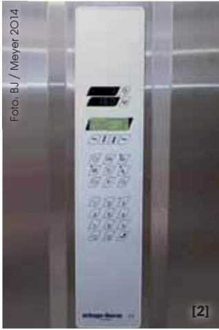
[1] Außenhülle und Backkammer der Futura-Öfen bestehen aus pflegeleichtem Edelstahl. Unter der Bodenplatte befindet sich eine Luftpolster-Unterkonstruktion, die als Isolierung dient. [2] Die Computersteuerung CP-200 ist für 99 Backprogramme ausgelegt und vernetzbar. [3] Wartungsrelevante Teile wie Ölbrenner oder Umwälzventilator sind leicht von vorne erreichbar. Die Steuerung ist wärme geschützt in einem geschlossenen Schrank in der Tür untergebracht. [4] Durch eine auf dem Drehteller angebrachte Galerie können Stikken fast aller Hersteller verwendet werden. [5] Durch diese Öffnung saugt das BQS-System Schwaden gezielt ab.
