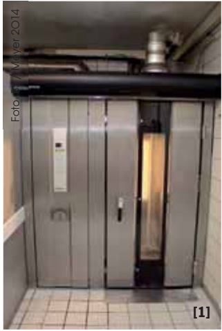
[1] Außenhülle und Backkammer der Futura-Öfen bestehen aus pflegeleichtem Edelstahl. Unter der Bodenplatte befindet sich eine Luftpolster-Unterkonstruktion, die als Isolierung dient. [2] Die Computersteuerung CP-200 ist für 99 Backprogramme ausgelegt und vernetzbar. [3] Wartungsrelevante Teile wie Ölbrenner oder Umwälzventilator sind leicht von vorne erreichbar. Die Steuerung ist wärme geschützt in einem geschlossenen Schrank in der Tür untergebracht. [4] Durch eine auf dem Drehteller angebrachte Galerie können Stikken fast aller Hersteller verwendet werden. [5] Durch diese Öffnung saugt das BQS-System Schwaden gezielt ab.
