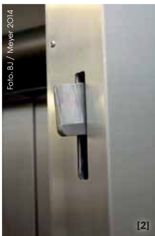
[1] Durch das Lösen zweier Rändelschrauben lässt sich die äußere Türscheibe leicht aufklappen, um die Fenster zu reinigen oder die Leuchtstoffröhre der Backkammerbeleuchtung auszutauschen. [2] Zum sicheren, dampfdichten Schließen der Ofentür befinden sich oben und unten im Türblatt diese schwenkbaren Riegel. [3] Die Messingrollen in der Türsäule mindern den Kraftaufwand beim Schließen und den Verschleiß der Schlossriegel. [4] Zwei Edelstahl-Spezialscharniere heben die Tür beim Öffnen an und schonen so deren Dichtung. [5] Dank dieses simplen Blechwinkels gehören auf dem Boden liegende Ofenhandschuhe endgültig der Vergangenheit an.
