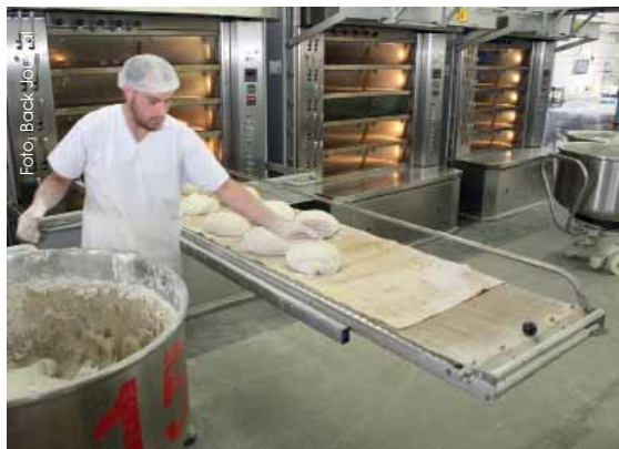
1. Bild: Hier wird gerade die rustikale 60/40er Roggenmischbrotssorte „Pfister Öko 1331“, benannt nach der ersten urkundlichen Erwähnung der Hopffisterei, ausgehen und auf die integrierte Beschickungseinrichtung aufgelegt. 2. Bild: Das Einschießen erfolgt leicht und schnell durch einen Mitarbeiter, die Herdtüren werden dabei von einem glatten Edelstahlbügel selbsttätig geöffnet. 3. Bild: Die ruhige und sanfte Strahlungshitze der Ringrohre sorgt für ein schönes Hochziehen der Brote.
