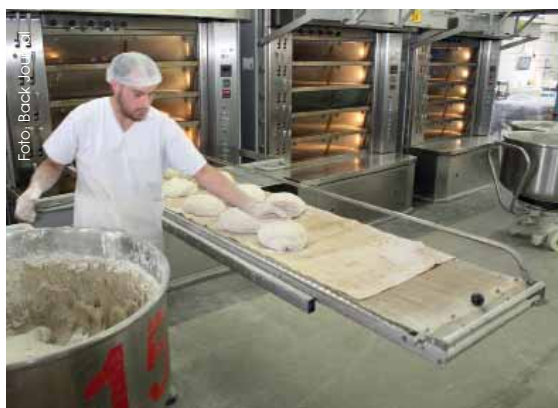
1. Bild: Hier wird gerade die rustikale 60/40er Roggenmischbrotsorte „Pfister Öko 1331“, benannt nach der ersten urkundlichen Erwähnung der Hopffisterei, ausgehen und auf die integrierte Beschickungseinrichtung aufgelegt. 2. Bild: Das Einschießen erfolgt leicht und schnell durch einen Mitarbeiter, die Herdtüren werden dabei von einem glatten Edelstahlbügel selbsttätig geöffnet. 3. Bild: Die ruhige und sanfte Strahlungshitze der Ringrohre sorgt für ein schönes Hochziehen der Brote.
