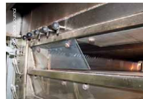
1. Bild: Die zweigeteilten Herdtüren lassen sich zwecks schnelleren Schwadenabzugs auch halb öffnen. Im Hintergrund sind die dicht hintereinander angeordneten Ringrohre zu sehen. Hinter der Abdeckung befinden sich von ihnen beheizten Gusseisenblöcke der ersten Schwadenanlage. 2. Bild: Die zwei Zentimeter starken Herdplatten bestehen aus einer in Stahlrahmen gegossenen, armierten Natursteinmasse. 3. Bild: Rechts im Bild ist die zweite, von den Abgasen des Gasbrenners beheizte Schwadenanlage zu sehen.
