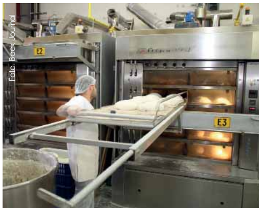
1. Bild: Hier wird gerade die rustikale 60/40er Roggenmischbrotssorte „Pfister Öko 1331“, benannt nach der ersten urkundlichen Erwähnung der Hopffisterei, ausgehen und auf die integrierte Beschickungseinrichtung aufgelegt. 2. Bild: Das Einschießen erfolgt leicht und schnell durch einen Mitarbeiter, die Herdtüren werden dabei von einem glatten Edelstahlbügel selbsttätig geöffnet. 3. Bild: Die ruhige und sanfte Strahlungshitze der Ringrohre sorgt für ein schönes Hochziehen der Brote.
