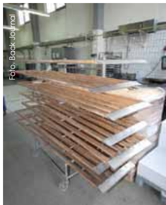
1. Bild: Mittels langer Brotrosten mit Griff und keilförmiger Metallkante werden die Brote direkt vom Herd aufgenommen und in einem Zug ausgebacken. 2. Bild: Das urige „1331“ zeichnet sich durch eine unregelmäßige Porung aus. 3. Bild: 2012 erhielt Stocker's Backstube den Umweltpreis der Stadt Lauf, wozu auch die Öfen beigetragen haben.
